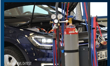
Le contrôle de pression vérifie l'étanchéité du système.
