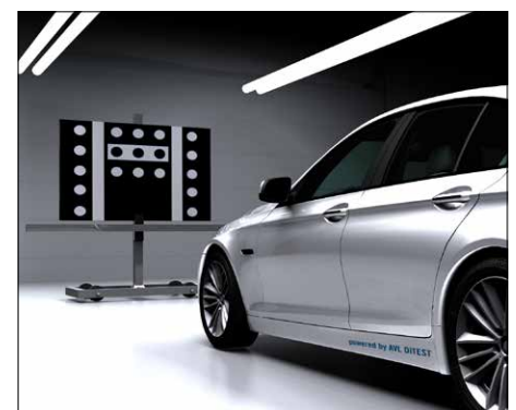
Mit XDS 1000 lassen sich ADAS-Sensoren kalibrieren.
