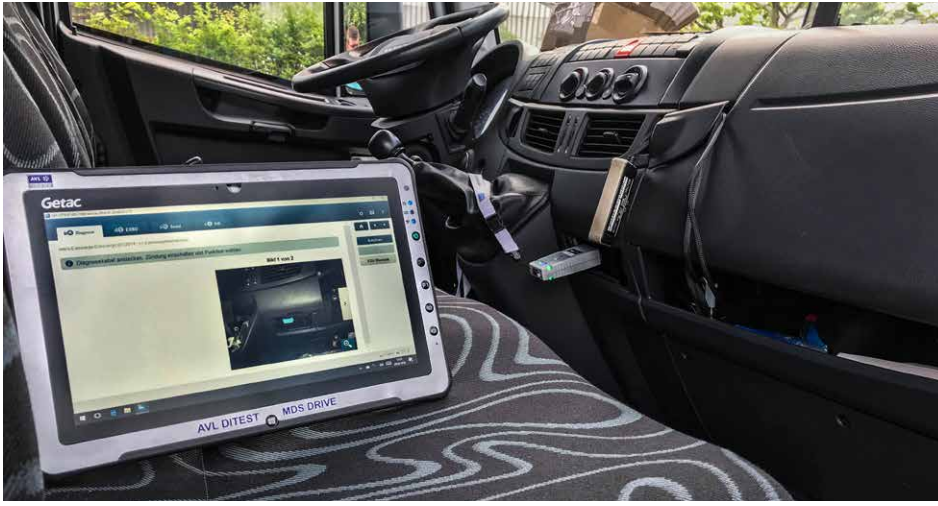
Der SCR-Manipulations-Detector entlarvt Umweltsünder ohne aufwendige Suchaktionen und Messungen.
