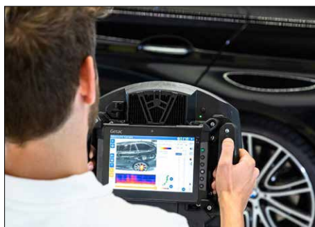
Die „akustische Kamera“ ACAM macht Geräusche auf einem Monitor sichtbar und verkürzt die Fehlersuchzeit signifikant.
